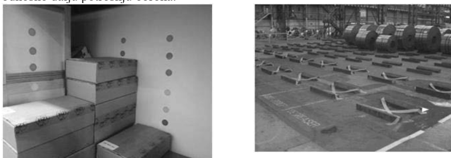
Slika 2. Primjer primjene kanban sistema na upravljanje zalihama putem praćenja minimalne i maksimalne potrebne količine zaliha.
