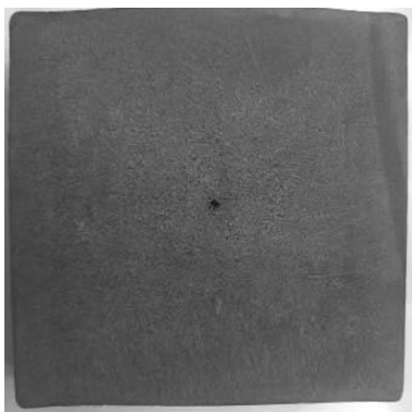
Slika 5. Makroploča gredice 150x150 mm, čelika B500B C – OL
