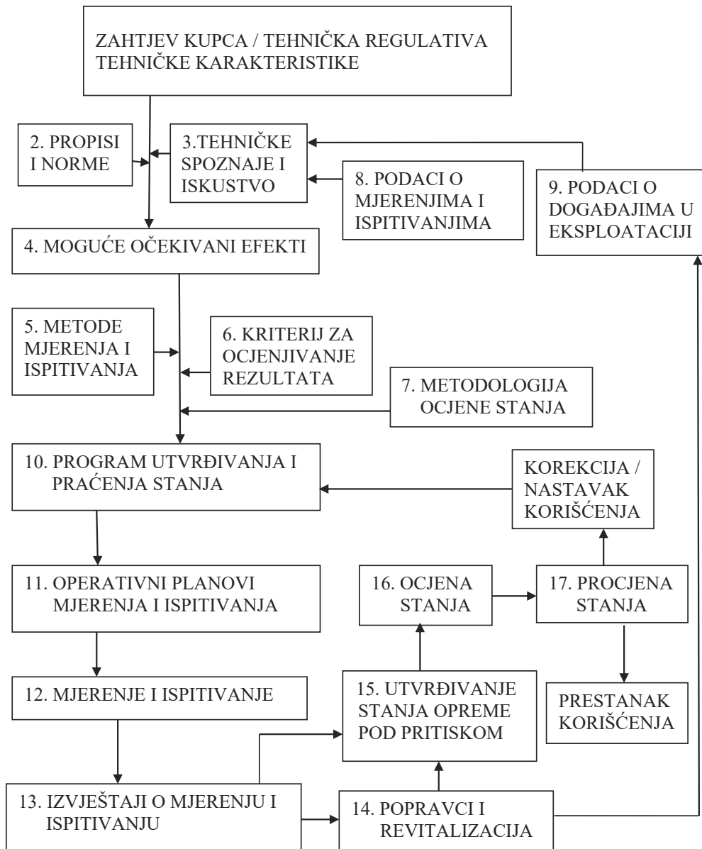
Slika 3. Algoritam „Q.A.“ sistema utvrđivanja i praćenja stanja opreme pod pritiskom
