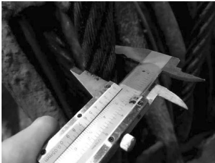
Slika 2. Primjer prikaza mjerenja poprečnog presjeka noseće sajle ispitivane dizalice
