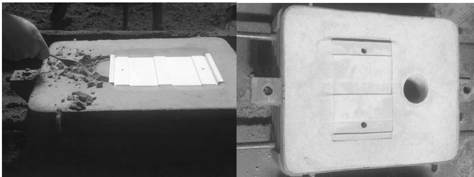
Slika 4. Izrada livačkih kalupa za ploču 1
